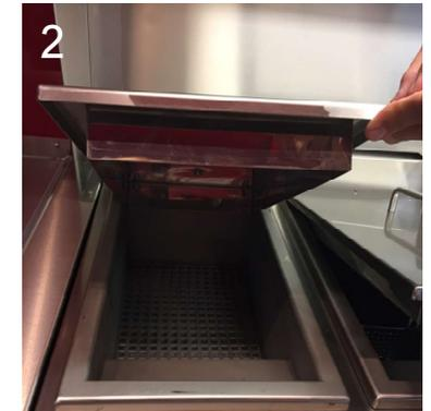
2. Dichtschließende, „schwere“ Deckel (beim Verfahren des Fahrzeuges)
